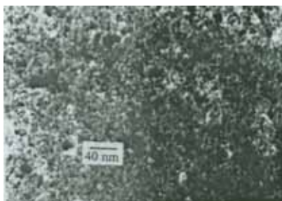
图 3 纳米氧化亚铜薄膜的 TEM [21]
