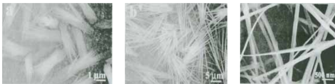
图 4 反相六边形液晶相电沉积氧化亚铜纳米线的 SEM(反应时间分别为 1h, 2h, 2h) [28]
