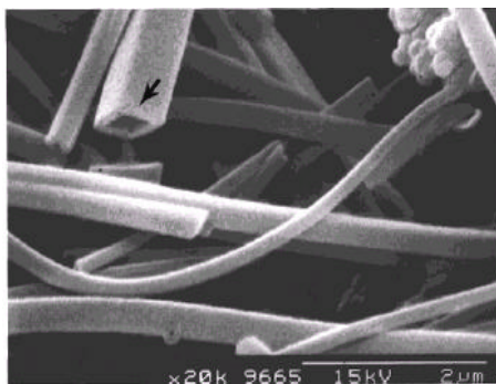
图 3 介孔氧化硅中空纤维的 SEM 照片 [40]
